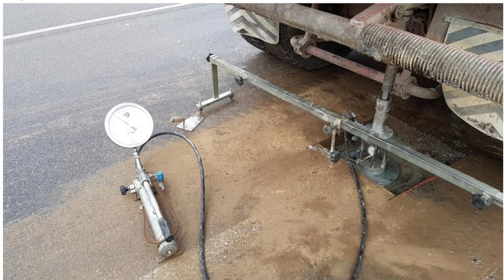
La piastra va disposta sulla superficie dello strato di cui si vuole determinare il modulo di deformazione, curando che il contatto sia il più completo possibile; a tale scopo, le eventuali irregolarità superficiali vanno livellate a mezzo di un sottile strato di sabbia.
